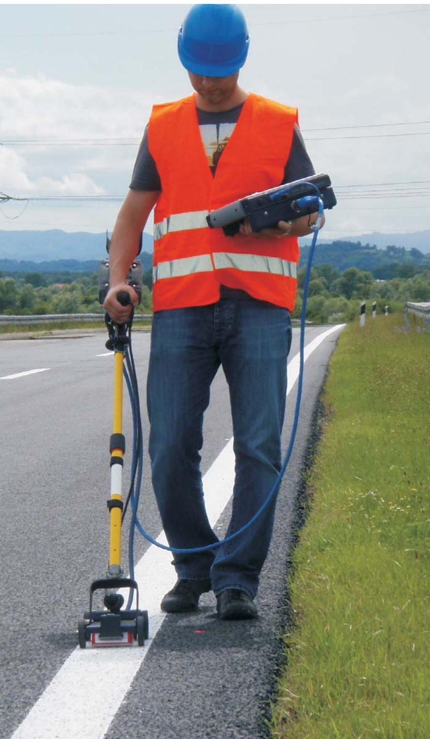
GPR ispitivanja cestovne infrastrukture daju podatke o debljini i stanju slojeva kolničke konstrukcije uz minimizirano vađenje uzoraka. Obzirom na kontinuirani karakter mjerena duž ispitnog profila, osim realnih podataka o debljini slojeva, moguće je detektirati i locirati anomalije u kolničkoj konstrukciji koje još nisu postale vidljive poput:
